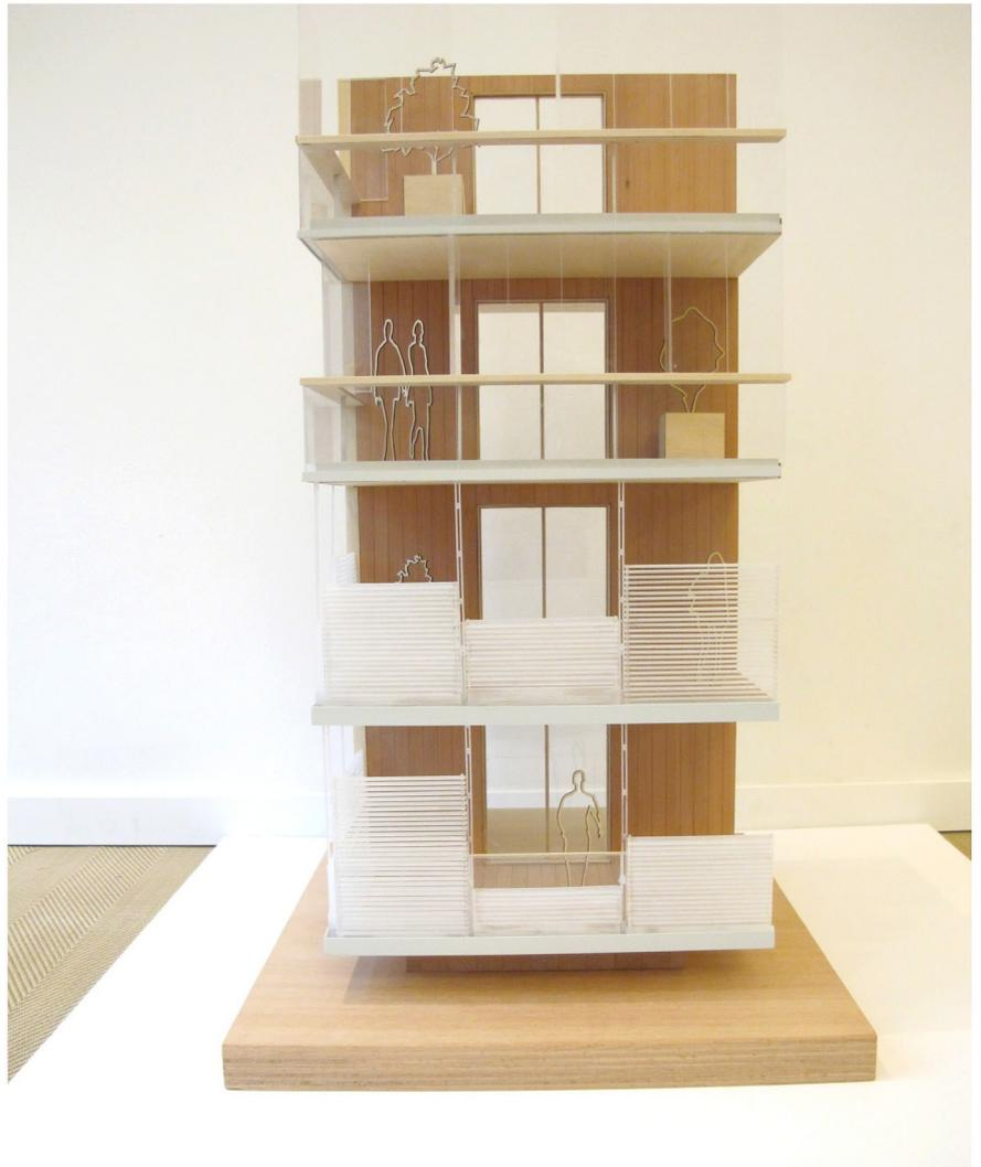
Réalisation d'un détail de façade à l'échelle 1/20ème de la maquette de concours de l'ilot J2, représentant dans tous ses détails 3 étages, y compris balcons, du bâtiment du projet.
